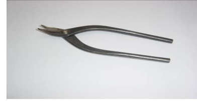
えぐり刃 (2丁まで) 寸法指定なし 形状指定なし 銅板専用の薄刃鋏も使用可
