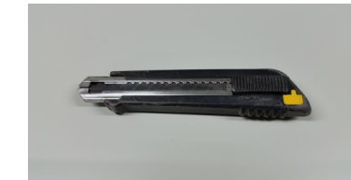
カッターナイフ (1本) 図面切り抜き用 養生材の切断 溶剤棒研削等
