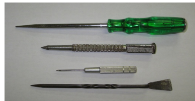
けがき針 (2本まで) ポンチ類 (2本まで) 形状・大きさに指定なし
