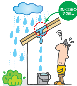
屋根の防水工事施工に不具合があり、雨水が家屋内に浸入してしまった。
